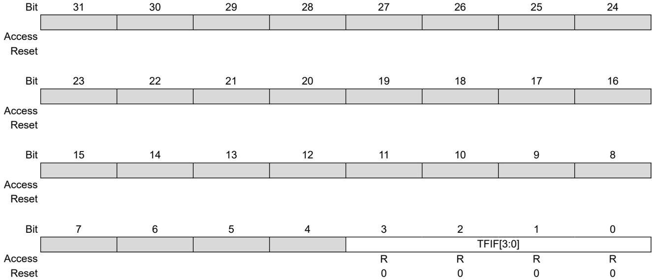
**Bits 3:0 – TFIF[3:0]** Transmit FIFO/TXQ Interrupt Pending
