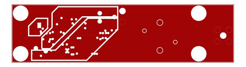
TEXAS INSTRUMENTS, INC. TSW2110 EVM PCB REV B POWER PLANE-LAYER 3
